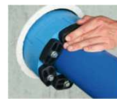
spingere il giunto e stringere le viti in modo alternato
